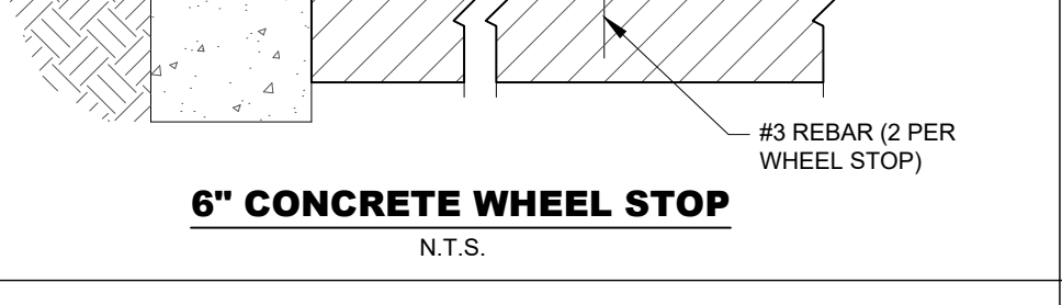
6" CONCRETE WHEEL STOP N.T.S.
